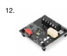
Interfaz para detector de viento para central RWA 4A e 8A cód. MX00 AU 04 N 0B 00
